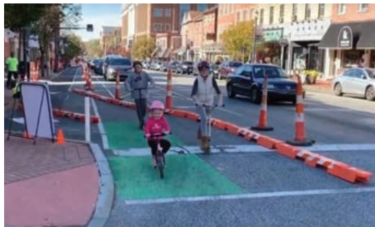
Figura 20 | Carros estacionados formam uma zona de intervalo ( buffer ) e ajudam a proteger os ciclistas na ciclovia (Filadélfia, Estados Unidos)
