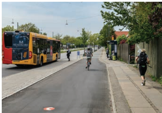
Figura 36 | Ciclovía protegida permanente com ponto de ônibus e estacionamento em Copenhague, Dinamarca
