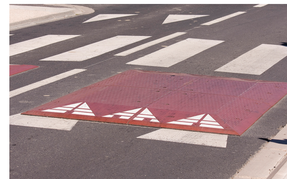
Figura 4 | Almofadas redutoras de velocidade feitas de borracha e aparafusadas
